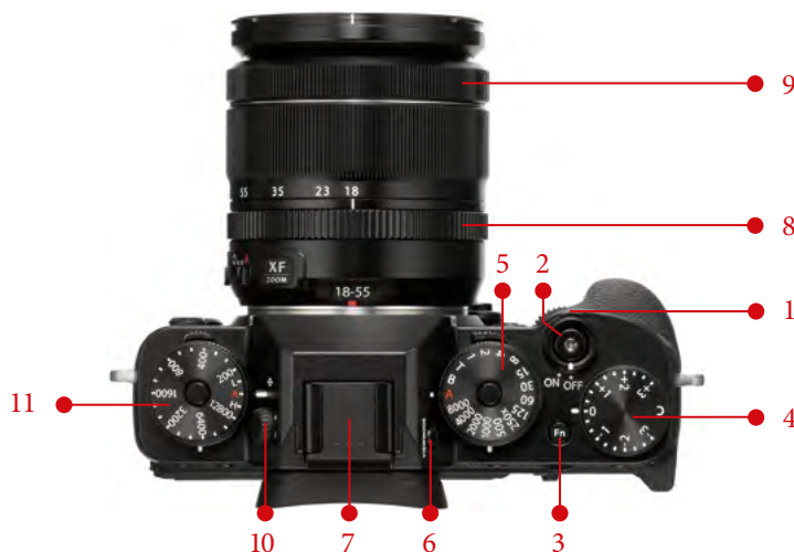
Рис. 2. Камера X-T2, вид сверху (с объективом XF18-55mmF2.8-4 R LM OIS): переключатель вкл/выкл (1), кнопка спуска затвора (2), функциональная кнопка Fn2 (3), диск экспокоррекции (4), диск выдержек, совмещенный с диском режимов экспозамера (5), кнопка VIEWMODE (6), горячий башмак (7), кольцо диафрагмы (8), кольцо фокусировки (9), регулятор диоптрийной коррекции (10), диск установки ISO, совмещенный с диском режимов затвора (11)
